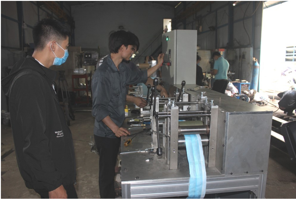
Dây chuy n sn xut khu trang t ng ca Công ty TNHH Châu à
